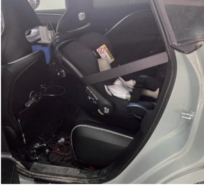
图 4 不带遮阳棚测试 Fig. 3 Test without Sunshade Canopy
